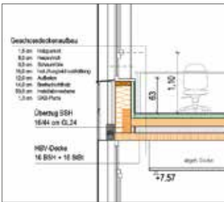
Für die Vorfertigung wurden 15 mm SterlingOSB-Großformatplatten von West Fraser in den Abmessungen 2,50 x 5,0 m genutzt, die für die dampfbremsende und luftdichte Ebene sorgen.
