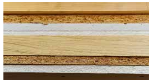
Für Wandbauteile mit aussteifender Funktion wurde die Dicke der SterlingOSB-Platten auf 22 mm erhöht.
